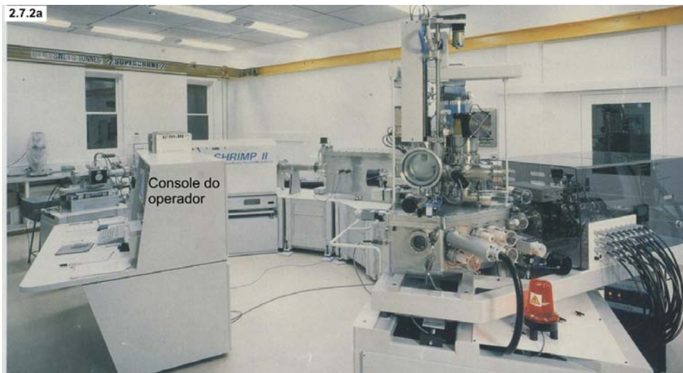
Figura 2.7.2a Fotografia da Microsonda iônica (de grande porte) SHRIMP II, em funcionamento no Laboratório de Geocronologia da Research School of Earth Sciences da Australian National University. Modelo correspondente ao adquirido pela Rede GEOCHRONOS).
